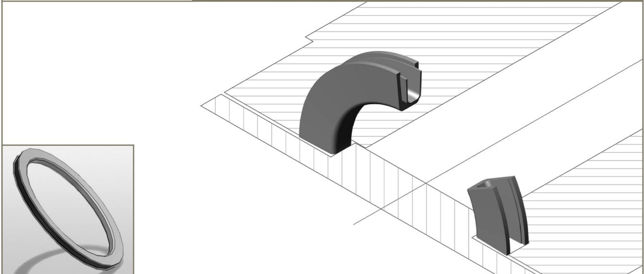
Das Profil JGF ist eine axial einfach wirkende Flanschdichtung für Außen- druck, die sich besonders für statische und quasi-statische Anwendungen eignet. Sie besteht aus einem U-förmigen PTFE-Dichtungskörper, in dem eine V-förmige Metallfeder als Vorspannelement eingesetzt ist. Die Feder macht die Dichtung dauerhaft elastisch, unabhängig von Veränderungen bei Betriebstemperatur, Druck etc. Die JGF Dichtung ersetzt in vielen Fäl- len die konventionelle O-Ring-Stützring-Kombination.
