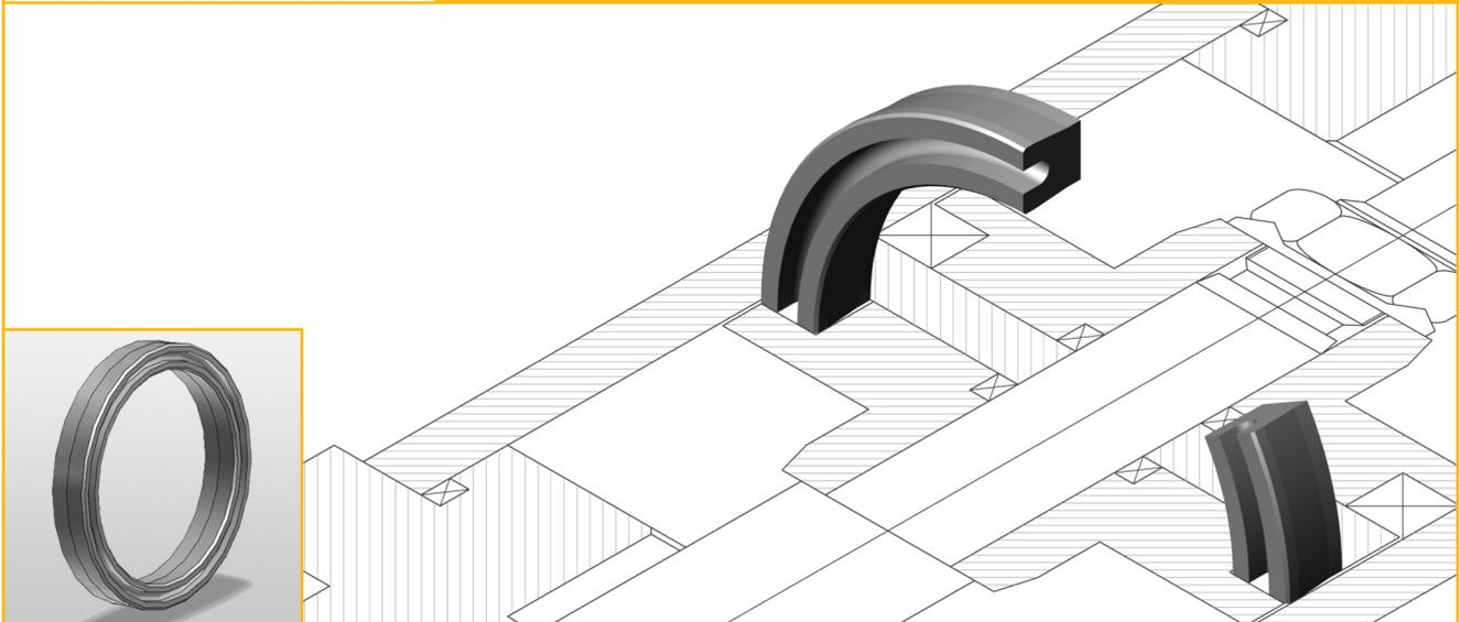
Der Nutring GDS ist eine symmetrische Lippendichtung aus hydrolysefestem Polyurethan mit Übermaß am Außendurchmesser. Hierdurch wird ein Festsitz im Nutgrund geschaffen. Durch die symmetrische Profilausführung kann er gleichermaßen als Stangendichtung und Zylinderdichtung eingesetzt werden.
