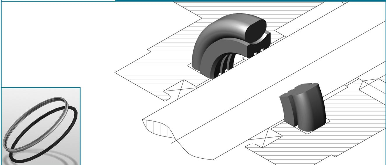
Der innendichtende Rotordichtsatz ORR ist ein doppelwirkendes Dichtelement, welches beidseitig oder wechselseitig mit Druck beaufschlagt werden kann. Er besteht aus einem hochwertigem PTFE-Ring für die dynamische Abdichtung (Primärdichtung) und einem O-Ring als elastisches Vorspannelement (Sekundärdichtung).
